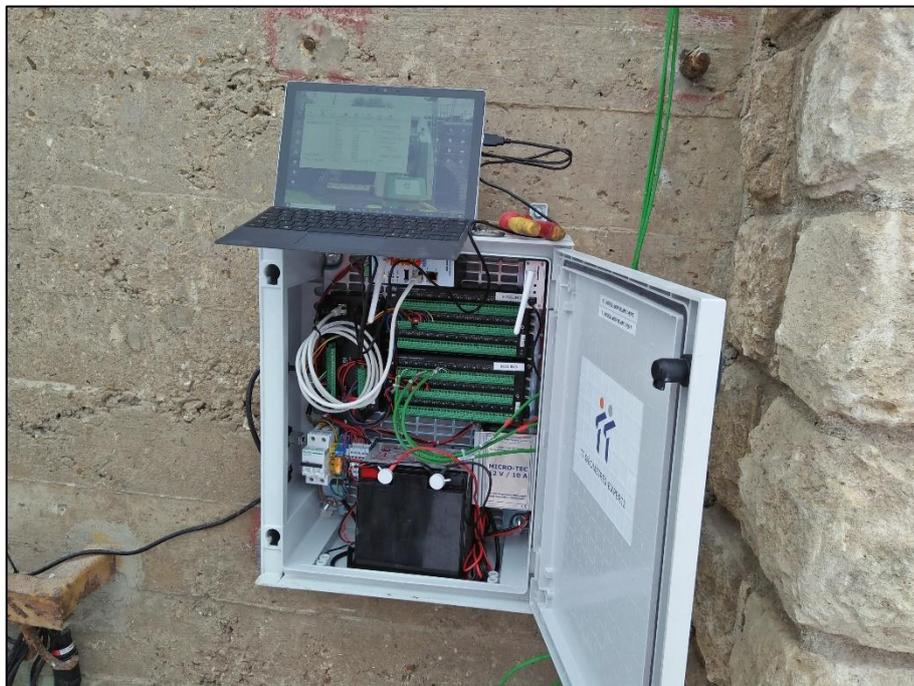
Figure 6 - Exemple de boîtier d'acquisition avec modem
