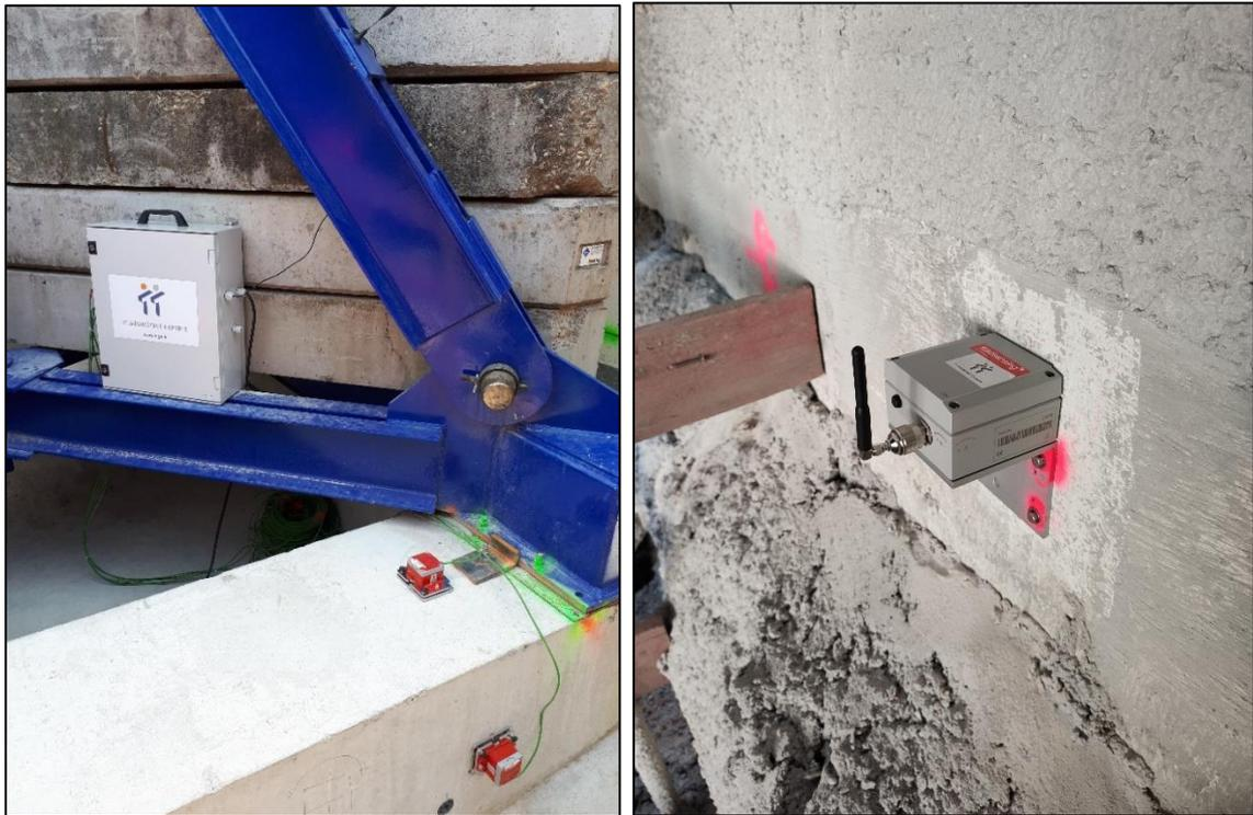
Figure 7 - Exemples de suivi de poutres support de grue et de voile contre terre
