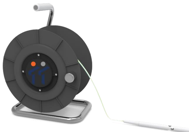
Figure 3 - Exemple de sonde piézométrique et son câble de mesure
