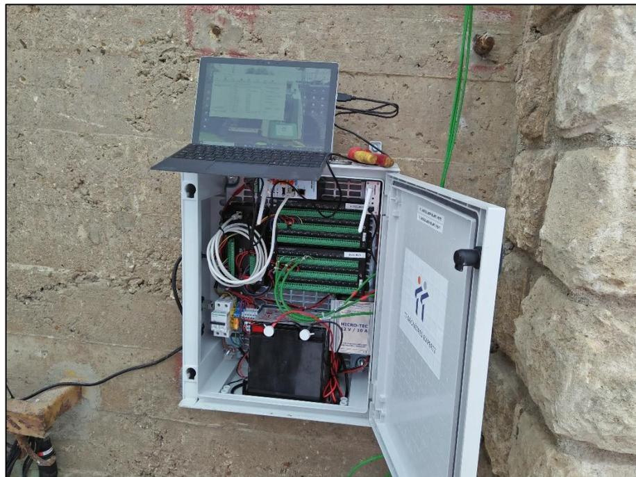
Figure 8 - Exemple de boîtier d'acquisition avec modem
