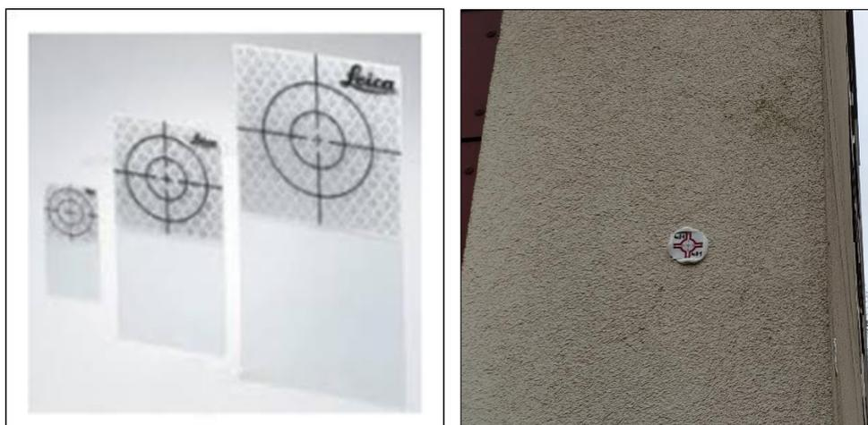
Figure 6 – Ciblettes réfléchissantes Leica
