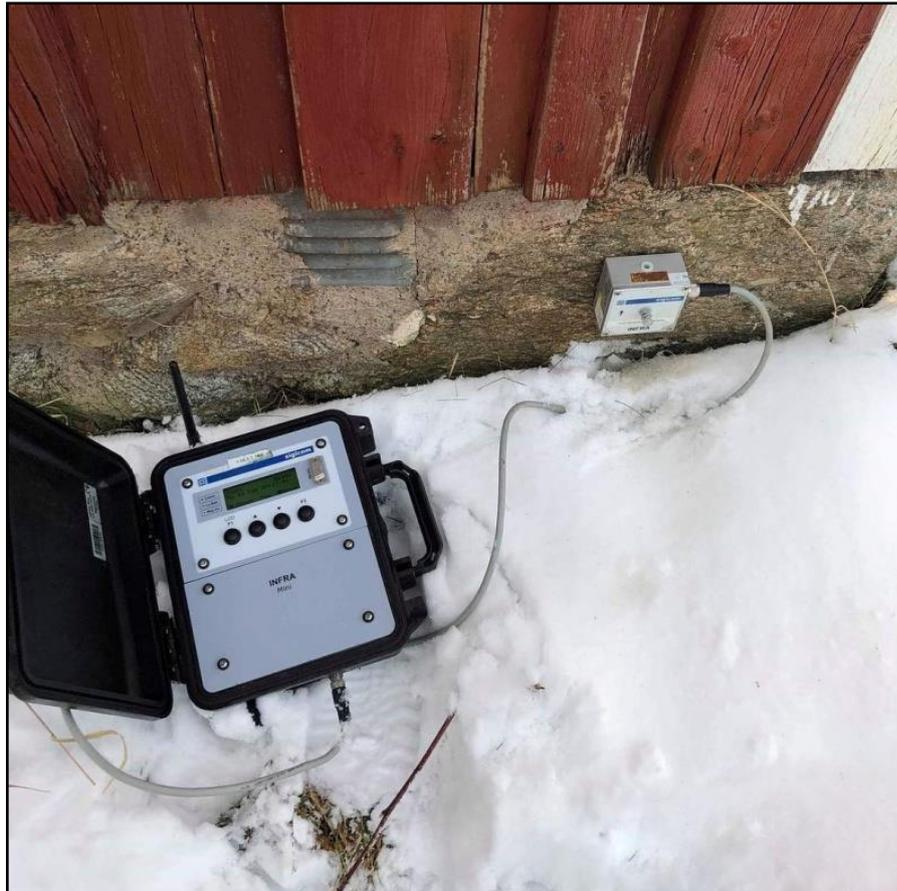
Figure 6 : Centrale de vibration avec un capteur
