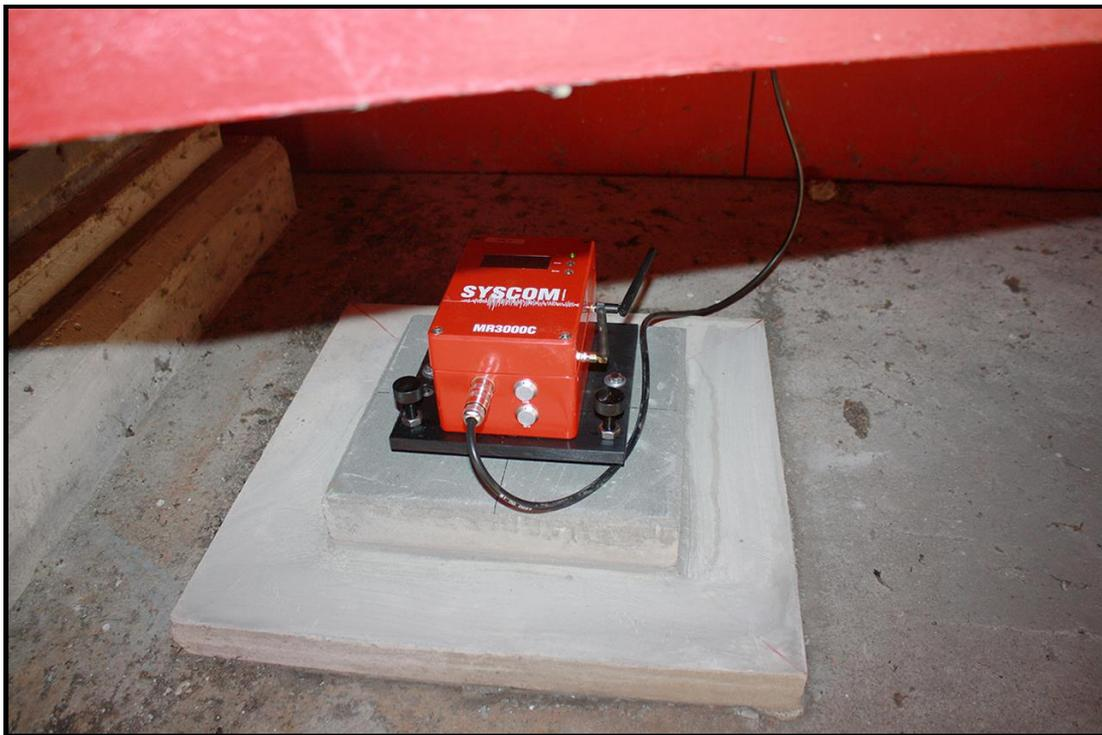
Figure 5 : Station de vibration
