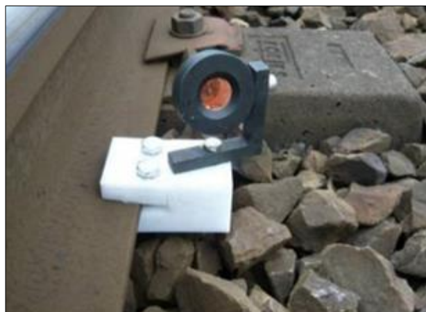
Figure 14 – Exemples de prismes installés
