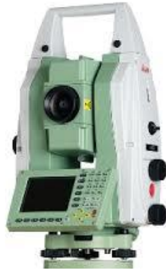
Figure 6 – Exemple d'une station totale motorisée (TM30)
